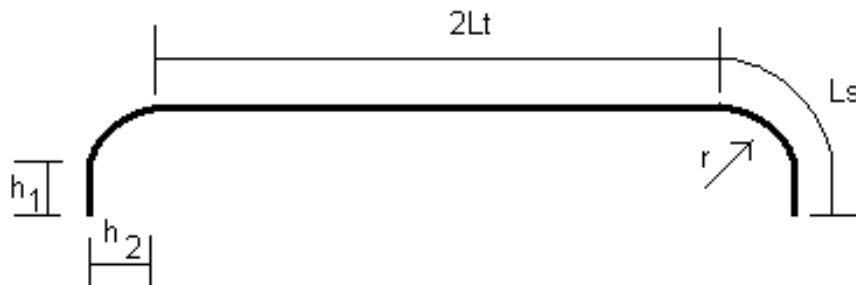
Figura 5-2: Geometría básica de la barra Antibalanceo
