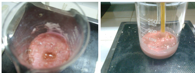
Figura 2.6. Formación de burbujas de óxido nitroso en el material sintetizado ( x = 0,03 ).
