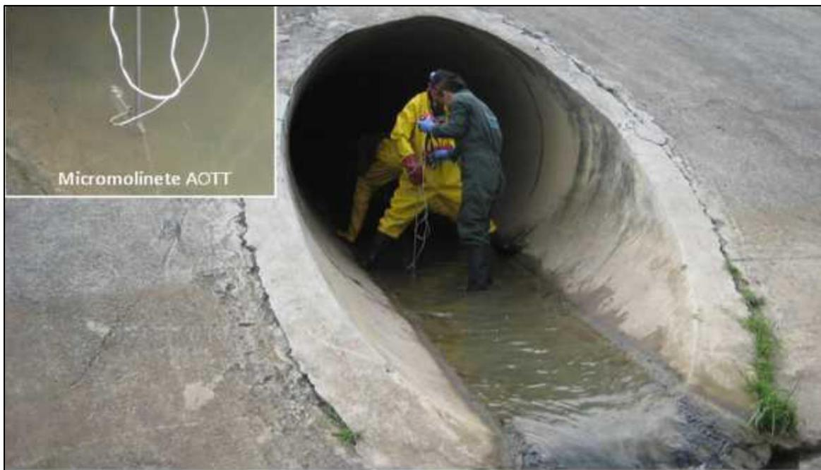
**Figura 3-5 Medición de la velocidad de la corriente con correntómetro**
