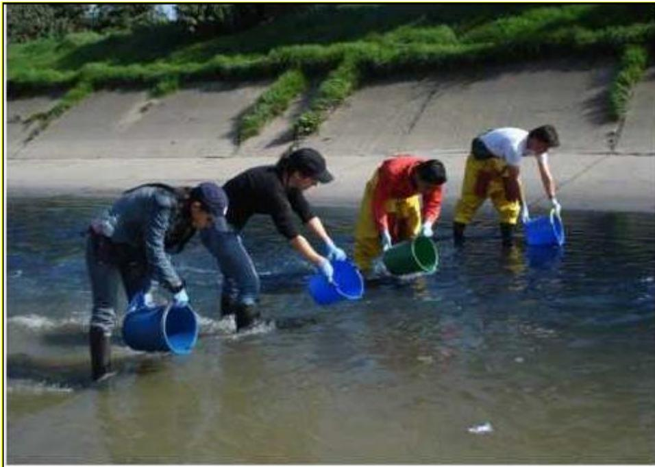
**Figura 3-3 Toma de muestra integrada en la sección transversal**
