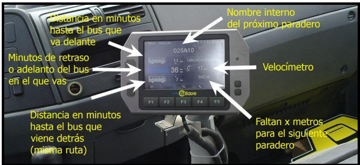
Figura 2-3: Unidad lógica del bus zonal.
