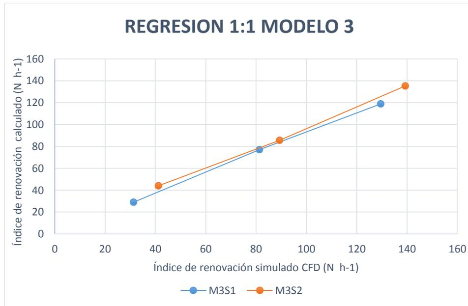
**Figura 3-11:** Relación entre los valores de índice de renovación (N h-1) simulados mediante CFD y calculados mediante el modelo de Boulard y Baille, para cada configuración de ventilación del modelo M3.
