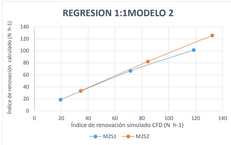
**Figura 3-10:** Relación entre los valores de índice de renovación (N h-1) simulados mediante CFD y calculados mediante el modelo de Boulard y Baille, para cada configuración de ventilación del modelo M2.
