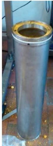
Ilustración 21 Tanque interior del extractor
