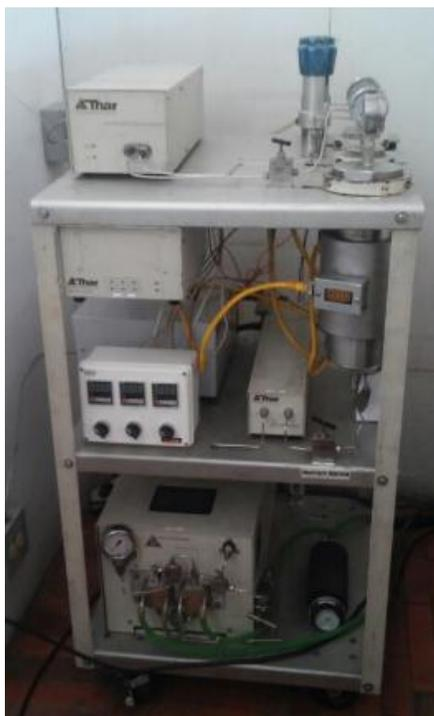
Ilustración 35 Equipo FSC flujo continuo
