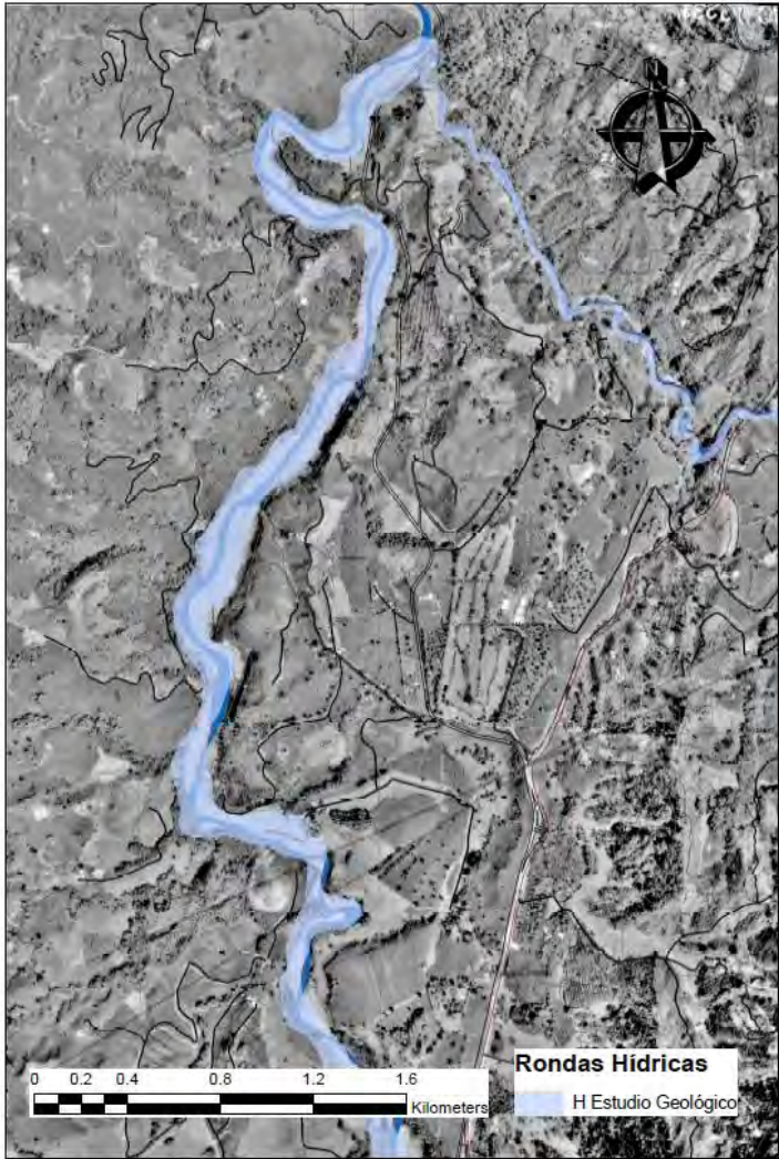
Figura 47. Resultados ronda hídrica mediante metodología que integra el componente geológico (Marulanda & Fonseca, 2013)
