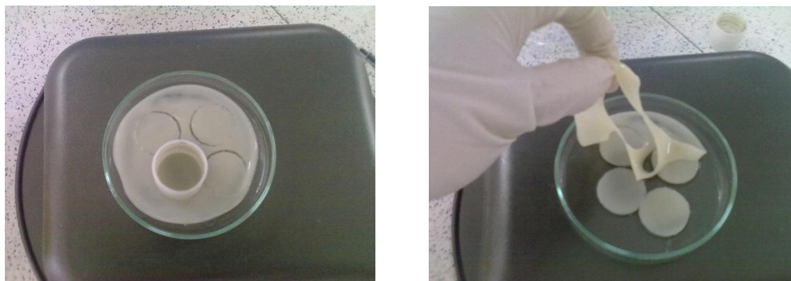
Figura 2-13: Molde para troquelar los geles
