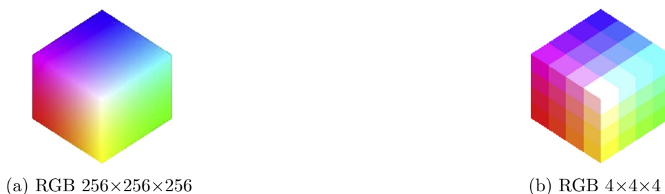
Figura 2-9.: Discretización de RGB reduciendo de (a) 16'777.216 niveles de color hacia (b) 64 niveles de color [124].
