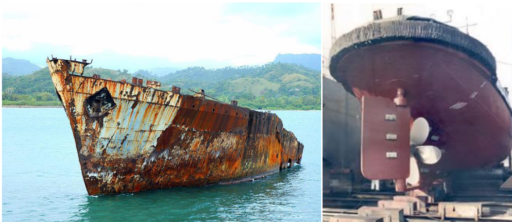
Imagen 5. Fenómenos de corrosión ambiental. (Suarez, CINETICA QUIMICA, 2014)
