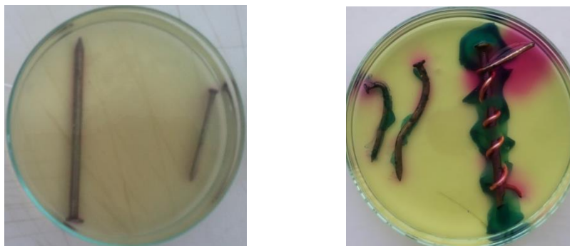
Imagen 20. Procesos de oxidación de las puntillas. En la fotografía izquierda se puede observar los clavos control que se utilizaron para poder referenciar los procesos normales de oxidación. En la fotografía derecha se observa como el daño mecánico y el cobre acelera los procesos de oxidación.
