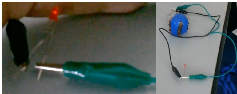
Imagen 7. Construcción pila voltaica. En la imagen se muestra el diseño utilizado por un grupo de estudiantes para encender un diodo LED con una pila de volta.
