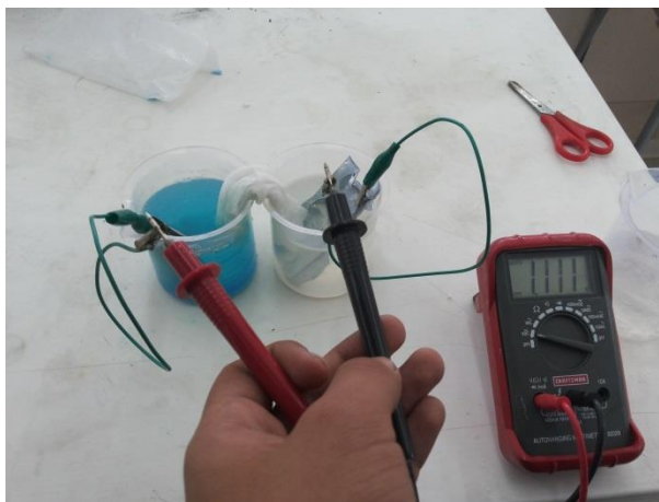
Imagen 38. Pila de Daniel con puente salino
