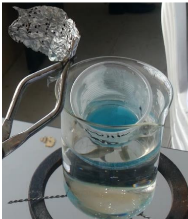
Imagen 33. Velocidad de la reacción con el efecto de la temperatura. En esta imagen se muestra como se acelera la oxidación del aluminio, aumentando la temperatura del sistema.
