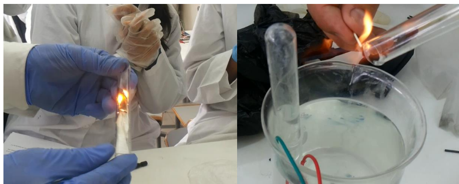
Imagen 26. Reacciones de ignición de los gases recolectados. En la parte derecha se muestra como un papel carbonizado vuelve a encender por la presencia del oxígeno. En la parte izquierda se observa como el hidrogeno emite una pequeña explosión al reaccionar con el oxígeno de la llama.
