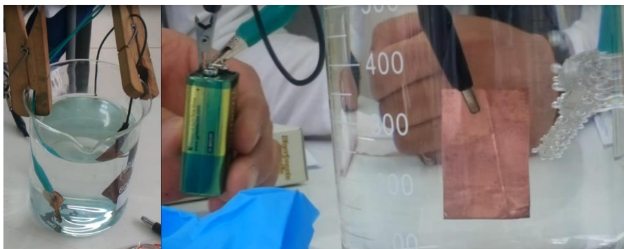
Imagen 16. Montaje de galvanización. En esta imagen se observan los diseños experimentales utilizados, para la realización de la práctica. En la imagen central se puede observar el proceso de reducción previo del hidrogeno, antes de que el metal se recubra con cobre.
