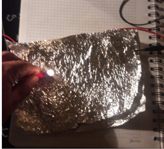
Figura 22. Foto de circuito con papel de aluminio.
