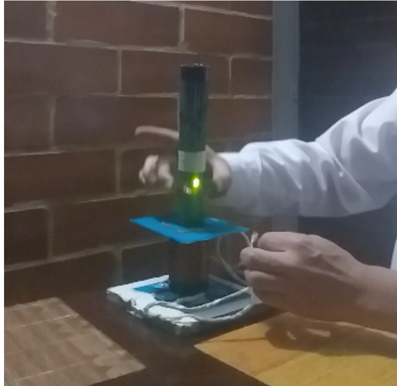
Foto 7 Cuando se hace pasar electricidad por un conductor este genera un campo magnético que a su vez genera un campo eléctrico inducido que origina el movimiento de cargas que hacen encender el bombillo led.
