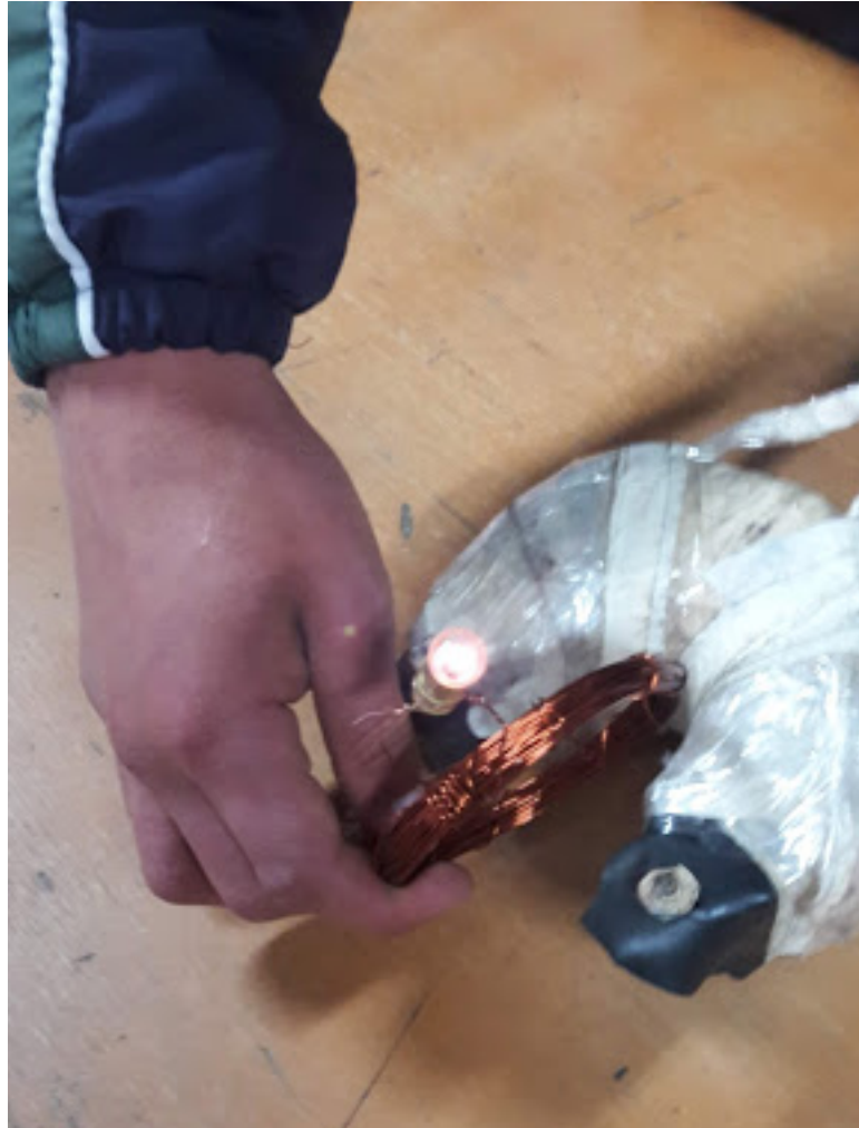
Foto2. Se muestra un bombillo encendido gracias a la corriente eléctrica inducida por medio de campo magnético que se generó al hacer pasar electricidad por un solenoide.
