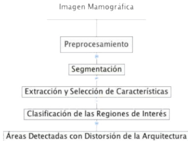
Figura 3.1. Diagrama general del método propuesto para la detección de distorsiones de la arquitectura de la glándula mamaria.
