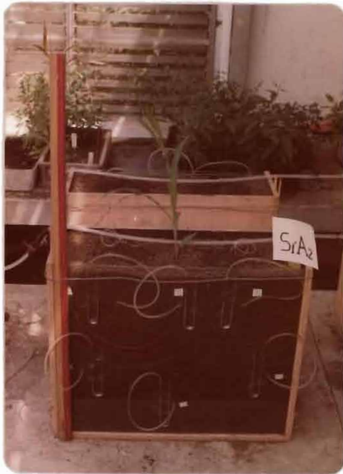
FIG 35 FORMACION Y AVANCE DEL FRENTE DE HUMEDAD EN S_1 CON A_2
