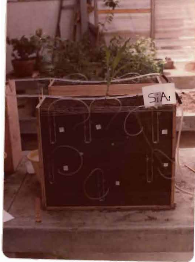
FIG 31 FORMACION Y AVANCE DEL FRENTE DE HUMEDAD EN S_1 CON A_1
