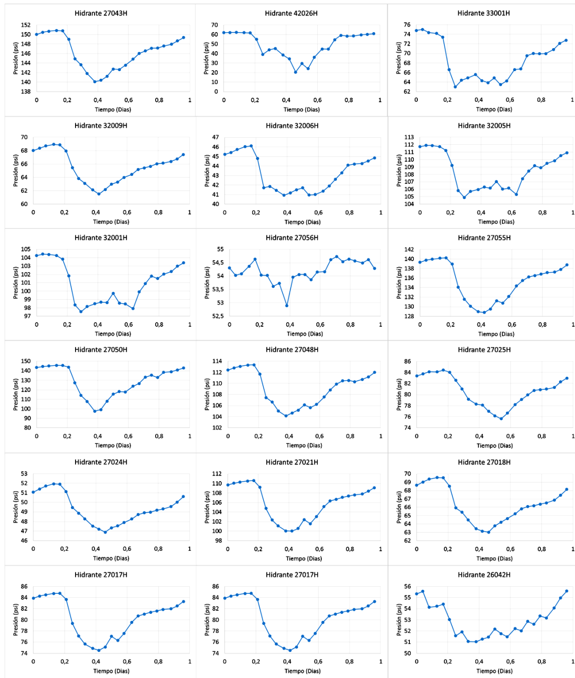
Figura 61. Curvas de presión circuito T23B derivación de 14 HF durante 24 horas (Elaboración propia con información de Aguas de Manizales, 2017)
