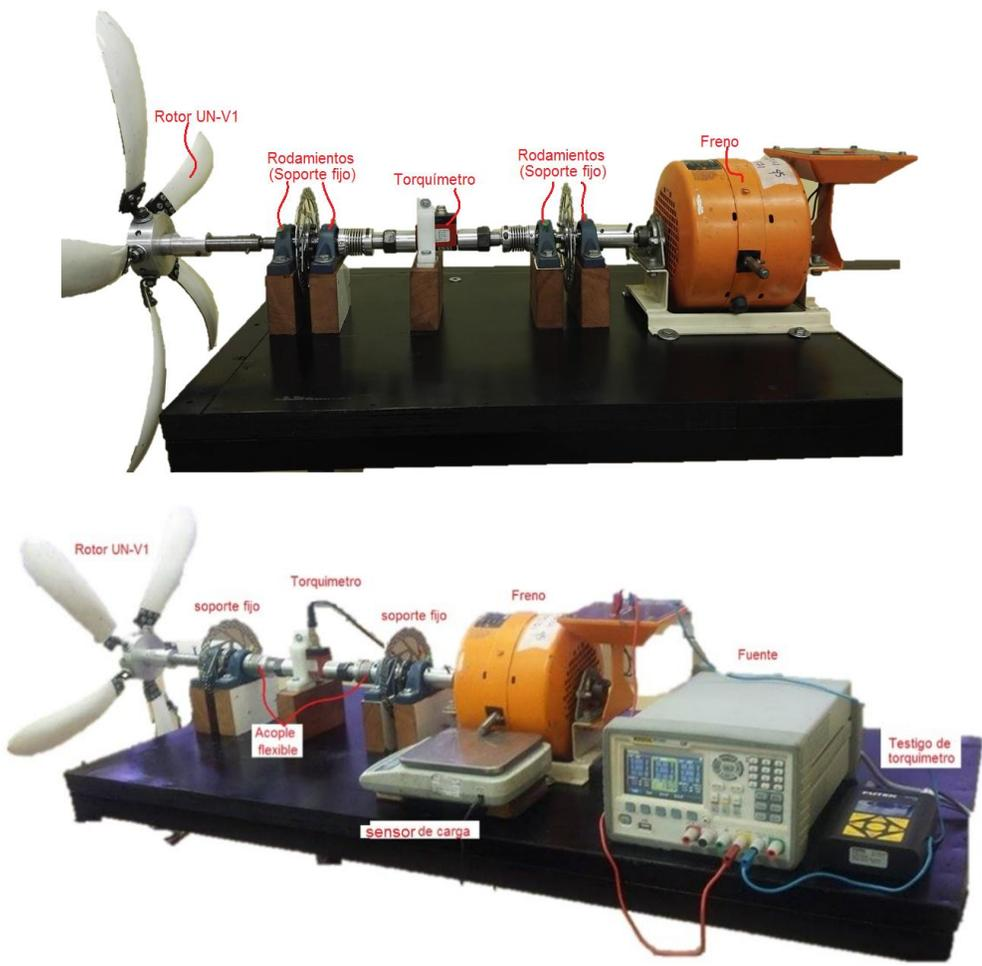
Figura 5-9. Despiece de la forma en que se ensambla banco de pruebas.
