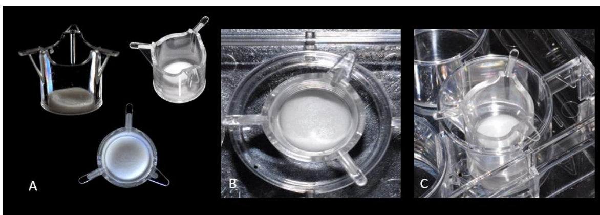
Figura 4. Diseño de soportes de colágeno I elaborados sobre Insertos Transwell. Una suspensión de 0,2 g colágeno I [5m/mL] fue depositada sobre insertos transwell de 13,8 mm de diámetro, con poros de 3 \mu m, congelada y liofilizada. A) Soportes 3D en insertos Transwell; B) Vista superior, C) Sistema soporte-Insertos transwell en pozo de placa de cultivo celular.
