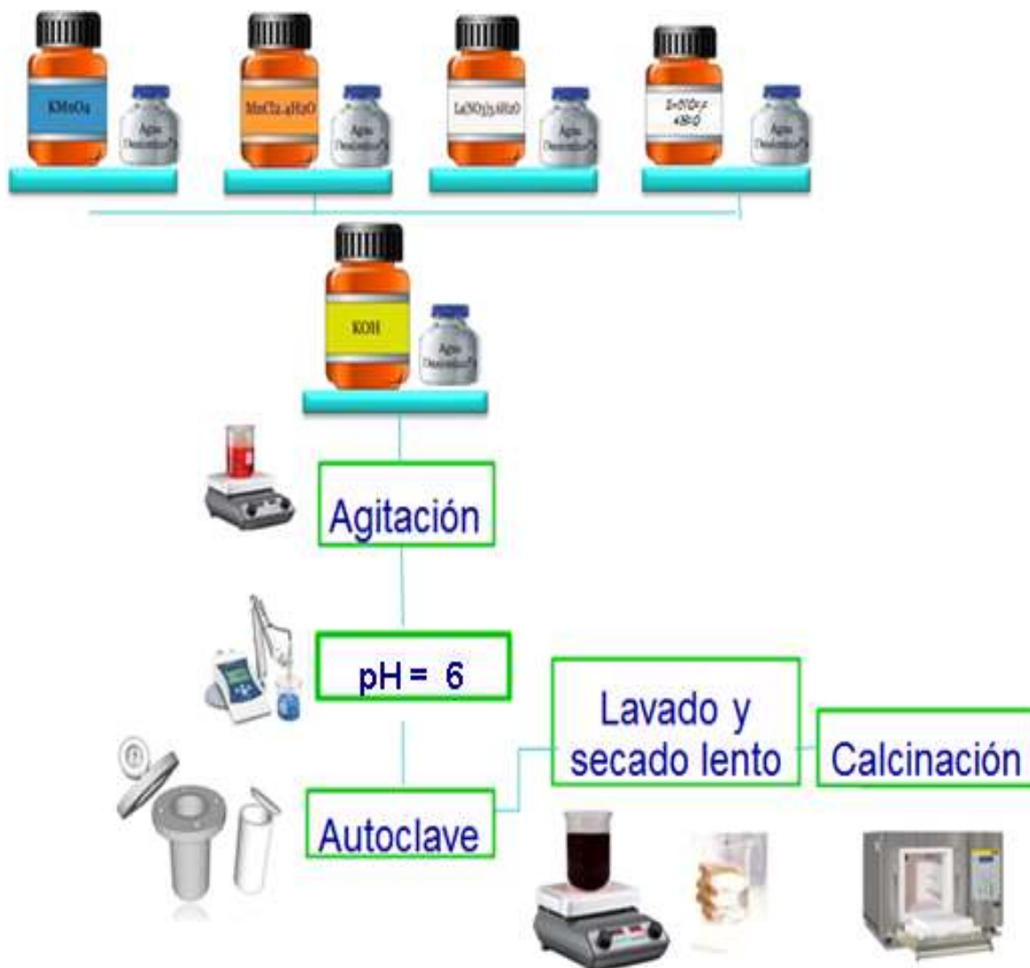
Ilustración 15. Proceso de síntesis de \text{La}_{1-x}\text{Sr}_x\text{MnO}_3 por el método hidrotermal con posterior calcinación [71].
