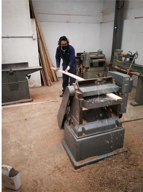
Finalmente, para la elaboración de los elementos de unión, se utilizaron 2 tablas de Pino Radiata de 19mm de espesor, 160mm de ancho y 3200mm de longitud que fueron seccionadas, con la sierra Tronzadora, marca DeWalt Ref. DWS 780, en piezas de 19mm de espesor, 160mm de ancho y 50mm de longitud para que sean los elementos de unión entre las piezas sueltas que solo serán ancladas con grapas industriales.
