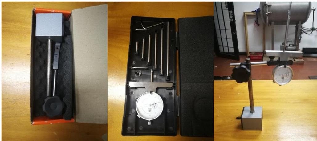
Este montaje se usó durante los primeros 8mm de deformación del elemento, ya que estos datos son usados para corregir los datos de deformación obtenidos con la máquina universal y además permitió establecer la carga que resiste la viga en la máxima deformación admitida por la Norma Sismo Resistente, para los elementos estructurales.
