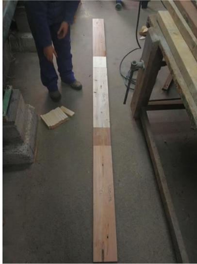
El proceso de instalación de los elementos de unión es realizado por ambas caras de la viga buscando una rigidez óptima para el traslado durante el proceso de encolado y demás movimientos a la que la viga se vea solicitada, permitiendo así, controlar que las vigas no tengas desplazamientos entre sus piezas o se cambien las piezas entre vigas.
