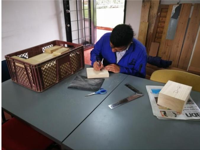
Además, se hizo la organización correspondiente de las piezas de cada una de las vigas para así poder tener organizados los ensambles con el fin de que las únicas tareas por realizar fuese anclar los elementos de unión y aplicar el adhesivo, para así poder tener los ejemplares listos para el prensado y posterior curado.
