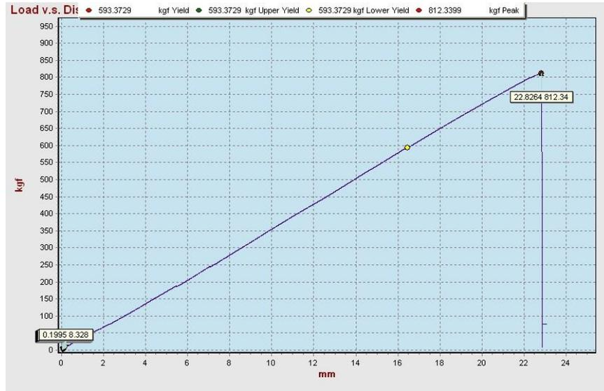
**Observaciones de la falla:** Se evidencia que la falla fue iniciada en el tercio de la luz por el cortante transversal inducido por los esfuerzos que resiste la viga, causando que el patín inferior fallara por tracción en las fibras, el elemento de unión y el patín superior fallaron por el cortante transversal que los fisuró, rompiendo las fibras. Los elementos internos de madera reciclable, no sufrieron ningún daño. Falla frágil.
