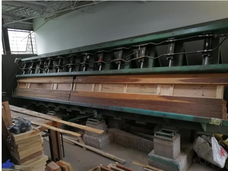
Luego del tiempo de prensado, las vigas se dejaron 6 días en el proceso de curado de la línea de cola en un lugar donde no pudieran ser afectadas por cualquier movimiento y humedad que afectara la resistencia del adhesivo.
