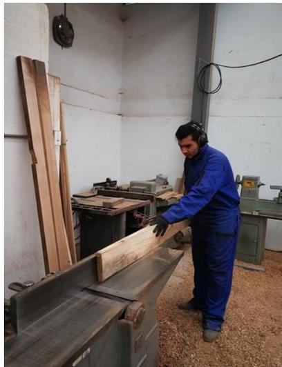
Después de realizar el proceso de planeado de 2 caras, procedemos a pasar la cara faltante por el cepillo eléctrico, el cual funciona con 3 cuchillas ubicadas en un rodillo giratorio el cual a medida que gira, aplicando presión sobre una superficie plana, la cual
