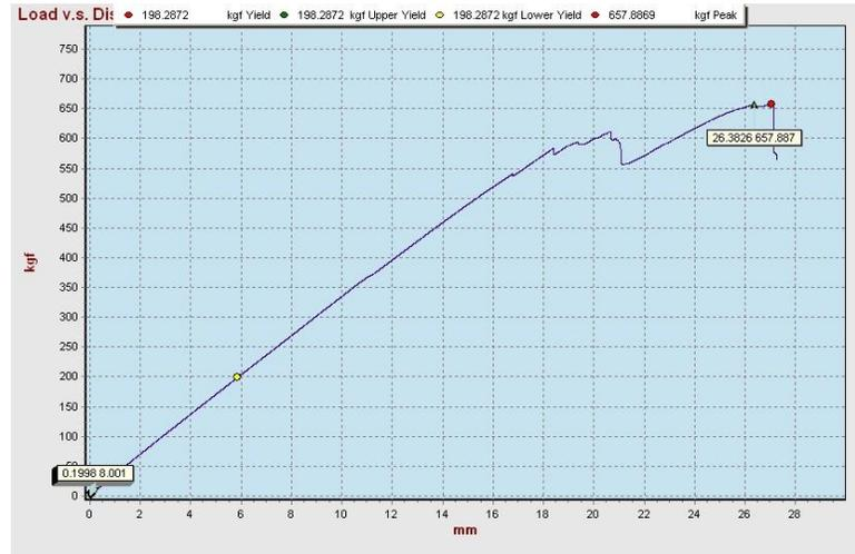
**Observaciones de la falla:** Se evidencia que la falla fue iniciada en el tercio de la luz por el desplazamiento de las piezas internas de madera reciclable, inducido por los esfuerzos que soporta la viga, causando que se generara un desprendimiento por la línea de cola y ninguno de los elementos de refuerzo fallaron visiblemente. Los elementos internos de madera reciclable, no sufrieron ningún daño. Falla frágil.
