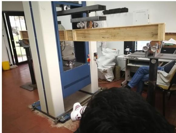
Para conocer la lectura de la carga ejercida durante todo el momento del ensayo, fue tomada del computador del equipo utilizado, el cual usa un programa que nos arroja la información tanto en valores como en gráficas; En cuanto a las deformaciones, la maquina nos arroja unos desplazamientos en mm que deben ser corregidos por medio de la toma de los valores en el centro de la luz con un comparador de caratula, marca Mitutoyo, con precisión de 0.1mm.
