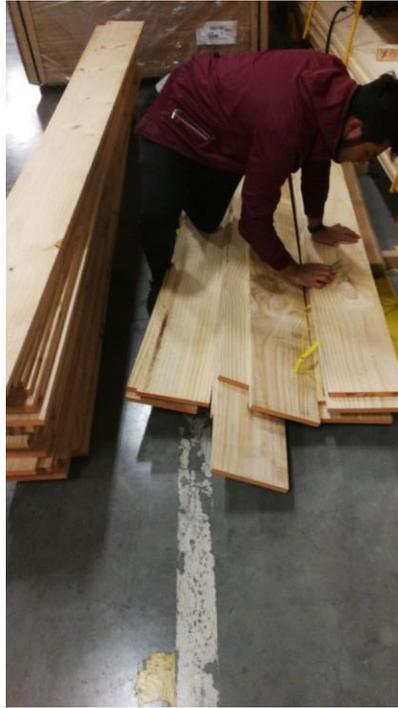
El Pino Radiata que se adquirió, es importado desde Chile, se encuentra con un contenido de humedad del 12%, ya que fue secado por medio de cámara de calor para un mayor control de estabilidad dimensional y ubicado en la estantería de forma apilada para evitar deformaciones por flexión.
