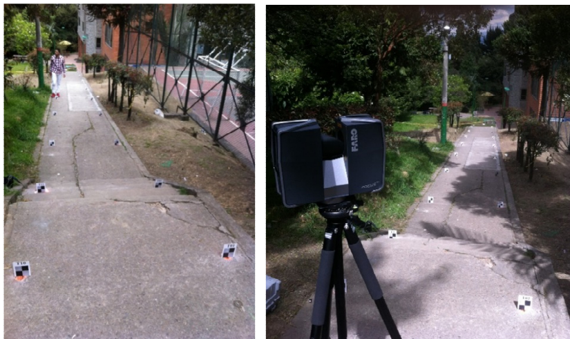
Figura 22. Los dos ejes con los targets colocados con respecto al escáner
