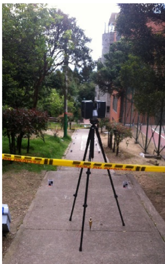
Figura 24. Cinta de seguridad y escáner
