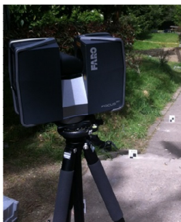
Figura 14. Escáner laser terrestre Faro 3D
