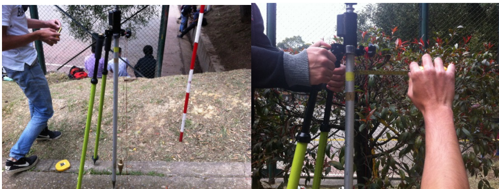
Figura 20. Base nivelante y control de perpendicularidad del prisma
