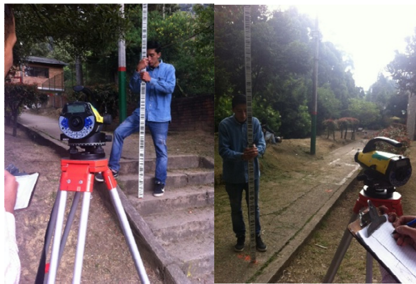
Figura 26. Detalle de nivelación con nivel electrónico
