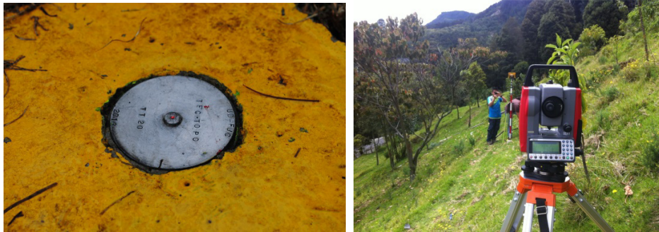
Figura 28. Placa TT20 y visual desde TT19 al cilindro No. 3
