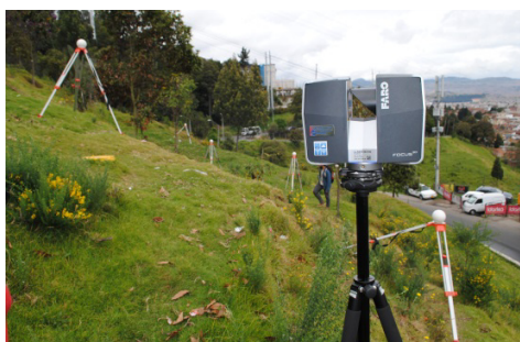
Figura 32. Vista de escáner y esferas sobre trípode
