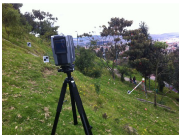
Figura 31. Vista de escáner, posición de targets y esferas sobre trípode
