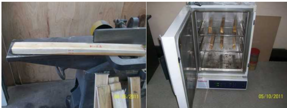
Figura 4-29: Maquinado y secado de lamelas para ensayo de corte en la línea de adhesivo
