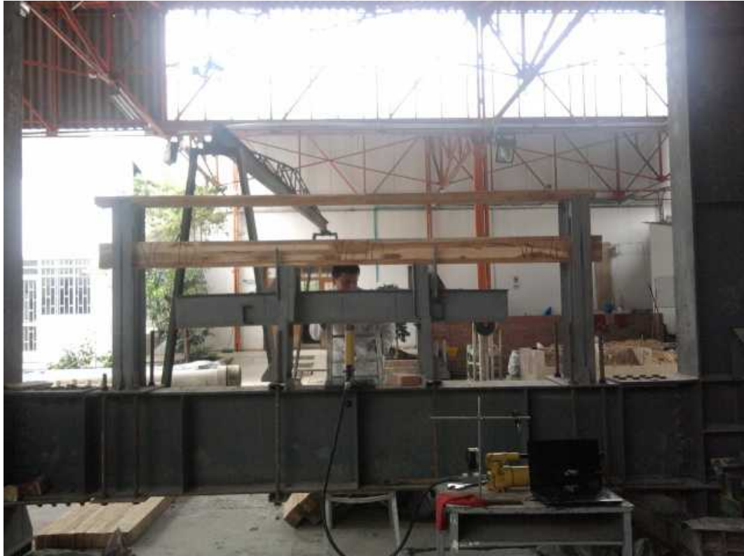
Figura 4-52: Montaje de la prueba de Flexión vigas tamaño estructural.
