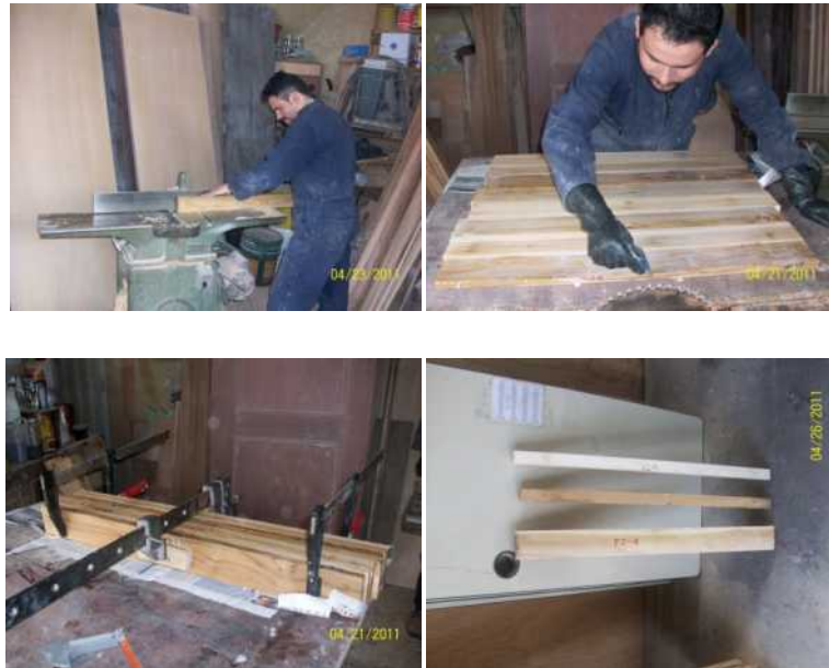
Figura 4-35: Cepillado, encolado, prensado y maquinado de probetas para ensayo de corte longitudinal por flexión
