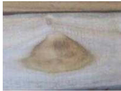
Figura 4-16: Fotografía de pieza de la investigación con nudos arracimados
