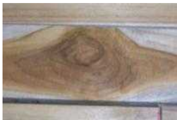
Figura 4-14: Fotografía de pieza de la investigación con nudo sano
