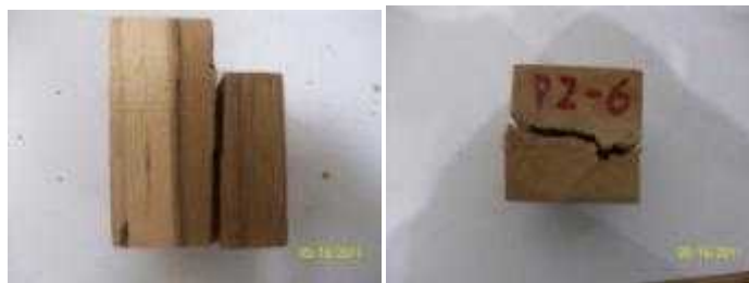
Figura 4-27: Vista lateral e inferior de falla típica del ensayo de corte paralelo al grano en teca
