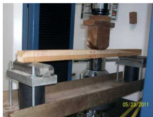
Figura 4-36: Montaje de prueba de corte longitudinal por flexión
