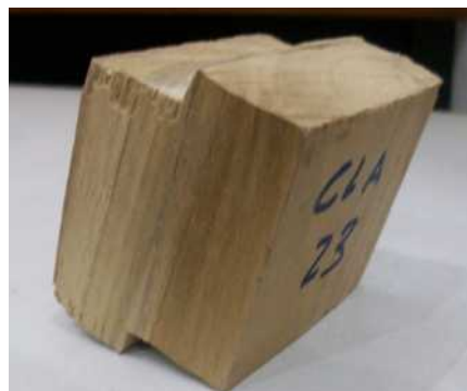
Figura 4-4: Probeta de ensayo de corte en línea de adhesivo
