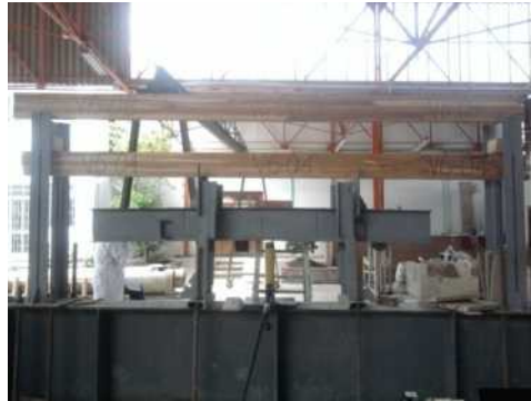
Figura 4-10: Montaje de prueba de flexión de vigas de tamaño estructural
