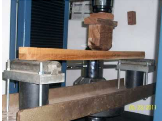
Figura 4-6: Montaje de prueba de corte longitudinal por flexión
