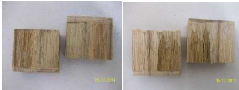
Figura 4-34: Imágenes de falla al corte en la línea del adhesivo en teca
