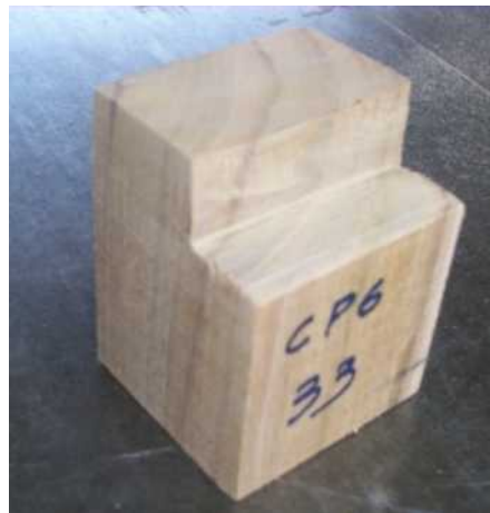
Figura 4-2: Probeta de ensayo de corte paralelo al grano en teca
