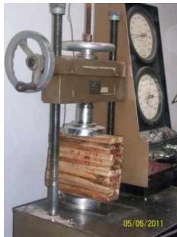
Figura 4-31: Probeta para ensayo de corte en la línea del adhesivo
