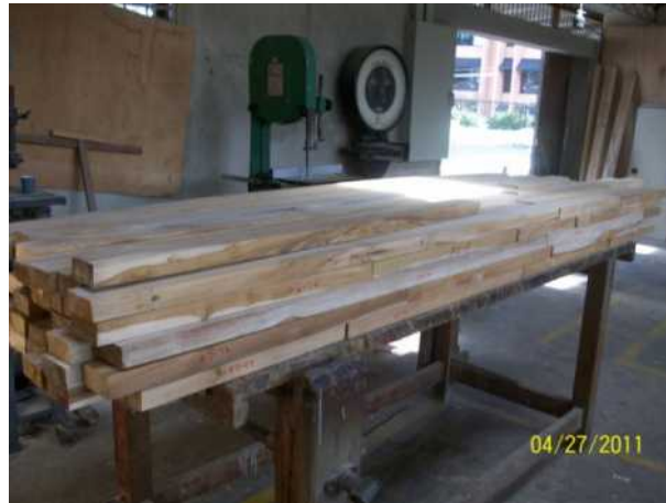
Figura 4-39: Fotografía de ensamble en seco de vigas en teca
