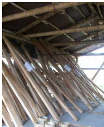
Figura 4-24: Proceso de secado al aire libre para lamelas de vigas de tamaño estructural
