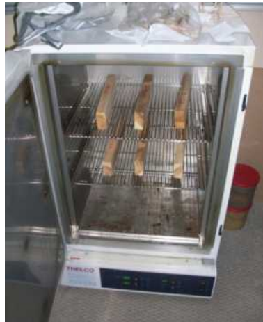
Figura 4-23: Proceso de secado de probetas pequeñas
