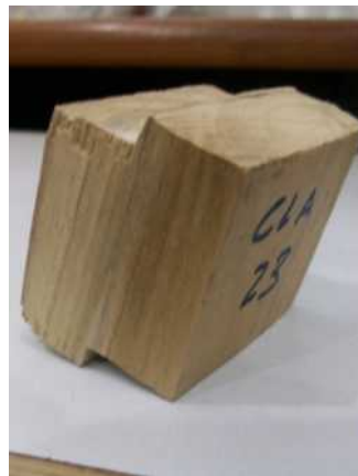
Figura 4-31: Probeta para ensayo de corte en la línea del adhesivo
