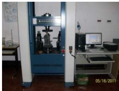
Figura 4-26: Montaje de Ensayo de corte paralelo al grano
