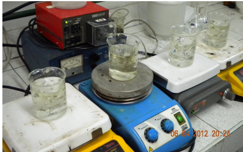
Figura 3-6: Proceso de inmovilización de las microalgas en alcohol polivinílico en solución saturada de ácido bórico.
