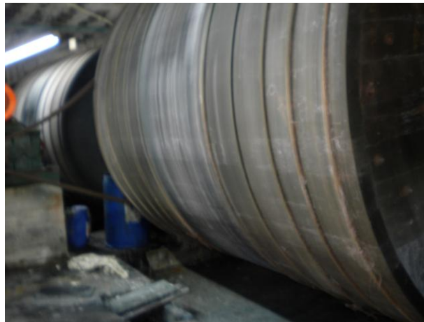
Figura 4-1: Bombos del proceso de piquelado y curtido de la empresa ITALCUR LTDA.
