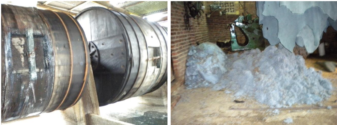
Figura 4-2: Curtiembre visitada en el municipio de Choncontá, a) área de la etapa de curtido (bombos de curtido y recurtido de pieles), b) recortes de cuero en Wet Blue.
