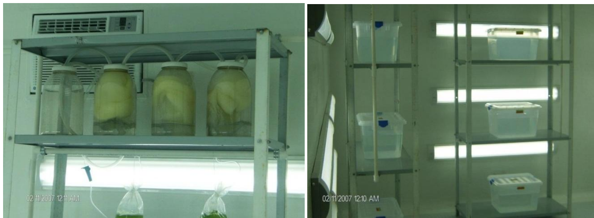
Figura 3-3: Cultivo de la primera fase, estación La Terraza – Villavicencio. Izquierda: sistema de aireación y control de temperatura. Derecha: Recipientes de cultivo de 20 L y sistema de iluminación.
