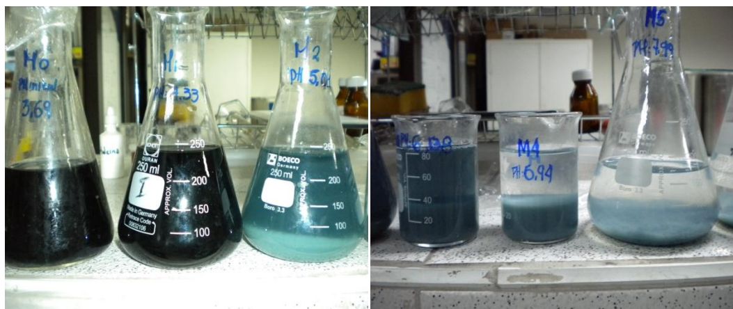
Figura 4-18: Pretratamiento del agua residual del proceso de curtido. Fuente: Autor.
