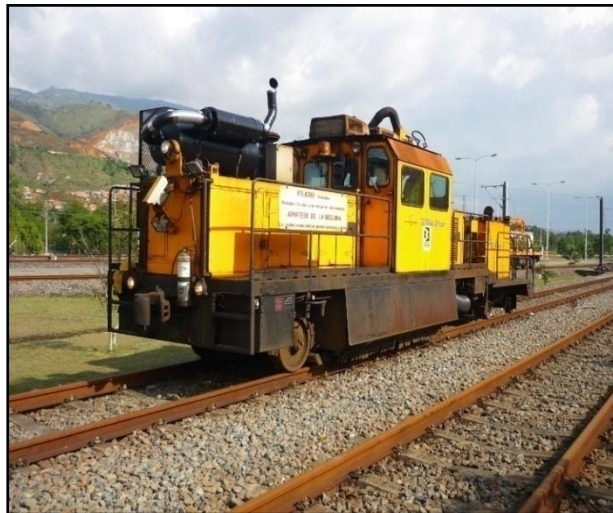
Figura A-5-3: Máquina reperfiladora de rieles.
