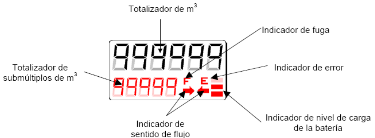
Figura 2-4: Sistema de visualización de datos medidor Aquabus Y290.
