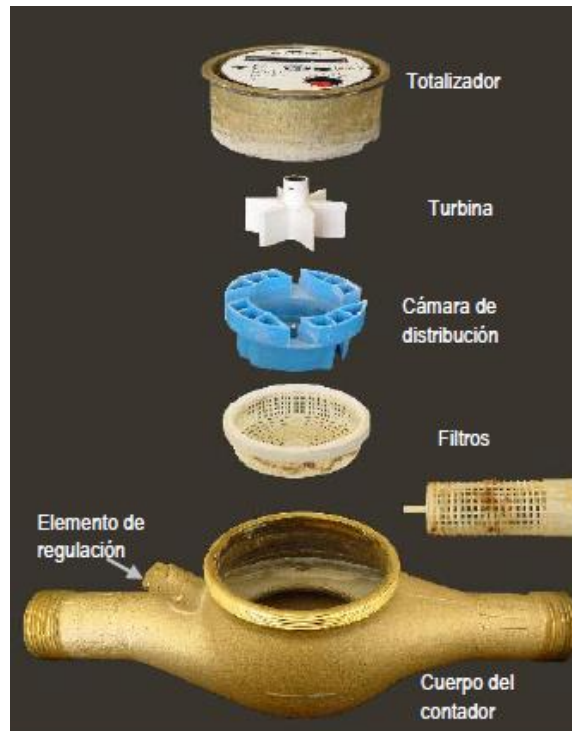
Figura 1-12: Despiece de un medidor de chorro múltiple.
