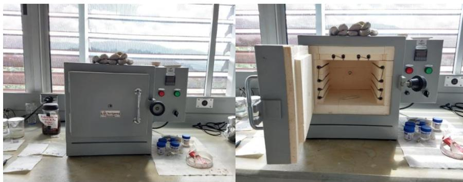
Figura 10. Montaje de oxidación en Atmósfera normal de aire
