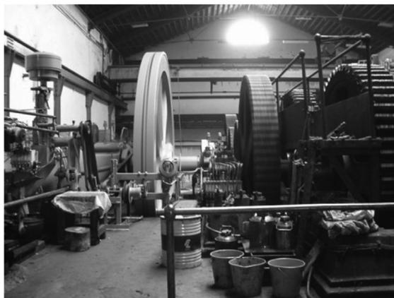
**Figura 2.** Máquina de vapor, volante de inercia y tren de engranajes (de izquierda a derecha)
