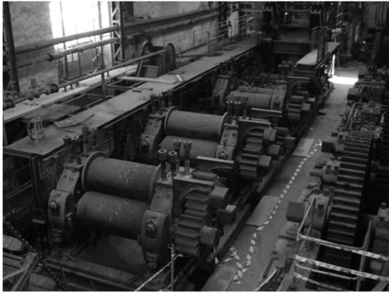
**Figura 1.** Molino horizontal de 3 rodillos
