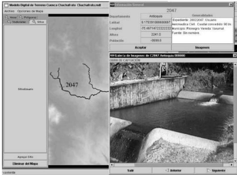
**Figura 5.** Ubicación del punto de captación 20022047 y visualización de la estructura de captación, mediante HidroSIG Java en el MDT de la cuenca.
