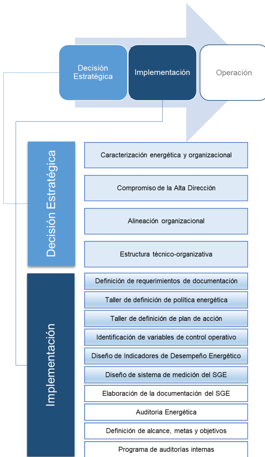
Figura 4. Metodología de trabajo con industrias programa PEN-SGIE (2010-2013). (Elaboración propia con base en la documentación del programa facilitada por el grupo de investigación GRISEC)
