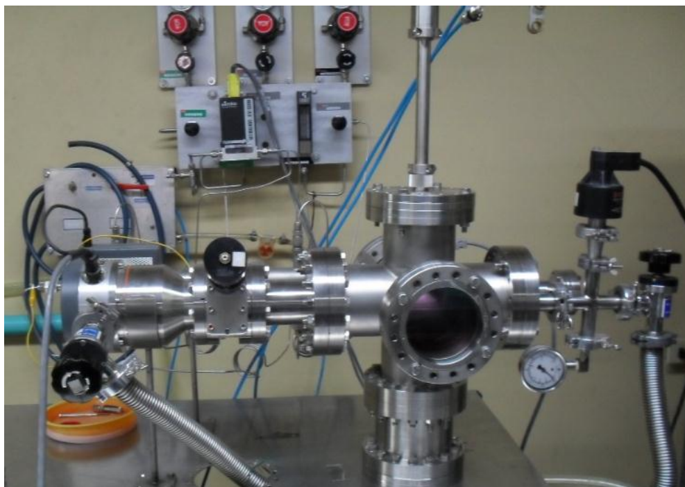
Figura 3.6 Sistema de pulverización catódica compuesto del sistema de bombeo cámara y sistema de enfriamiento.
