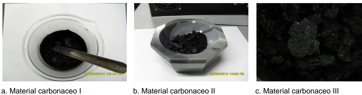
Figura 3.2 Diferentes presentaciones del material carbonaceo obtenido al someter la muestra a 200^\circ\text{C} por 6 horas.
