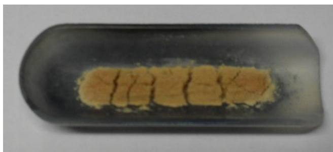
Figura 3.3 Producto sinterizado de dióxido de estaño dopado con hierro.
