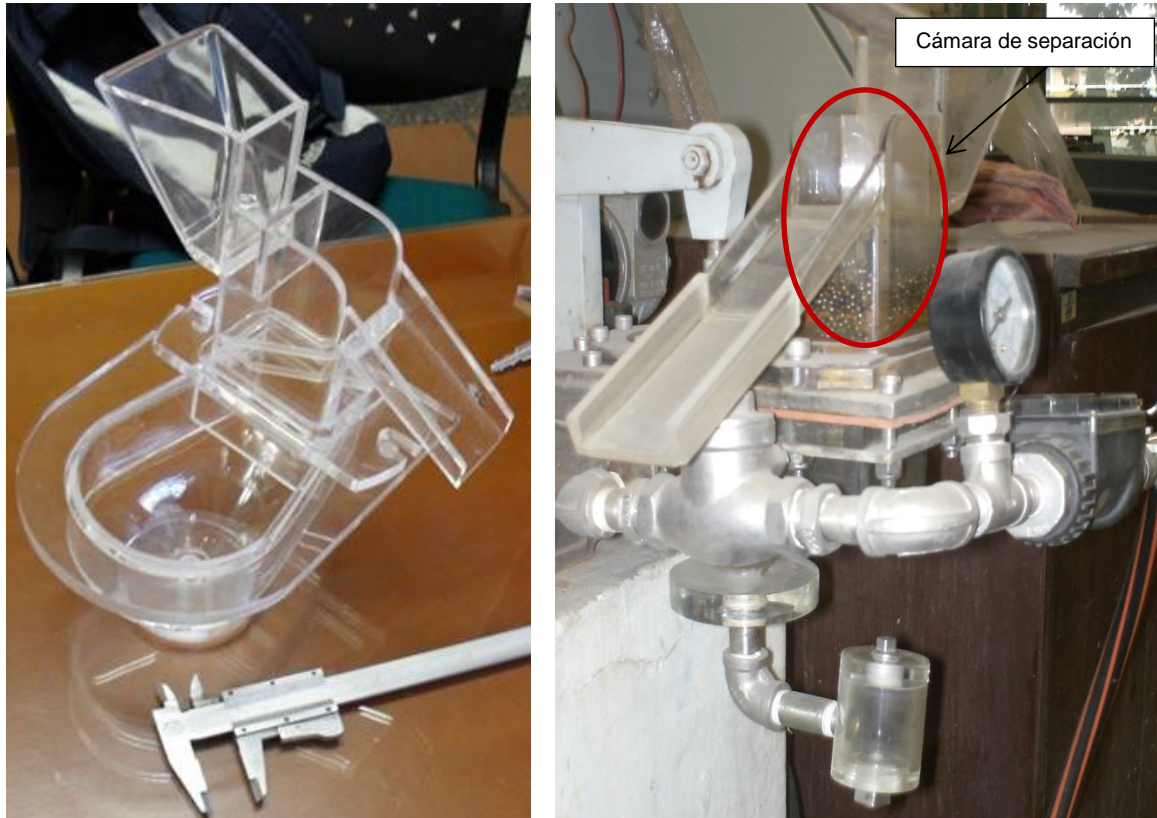
Figura 4-1: Jig a escala de laboratorio usado en la simulación.
