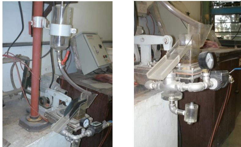
Figura 3-7: Concentrador jig a escala de laboratorio.
