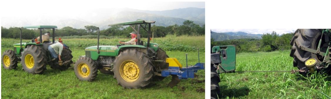
Los experimentos se realizaron durante 6 días no continuos (21, 23, 28 de septiembre y 5, 12 y 20 de octubre de 2010), con objeto de obtener condiciones de humedad y densidad del suelo diferentes. En cada uno de los días seleccionados se trabajó con una herramienta nueva, cada una trabajó 10 líneas experimentales de 28 m c/u (diez replicaciones) y espaciamiento entre ellas de  $1,10 \pm 0,1$  m.
