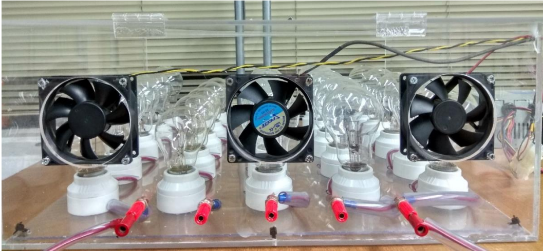
Figura 6-3: Carga resistiva de alta tensión construida
