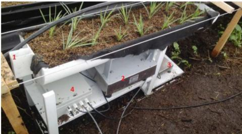
Lisímetro de pesada instalado en cama de cultivo, consta de 1. Contenedor, 2. Balanza contenedor, 3. Balanza recipiente lixiviado, 4. Electrónica de medición y transmisores inalámbricos
