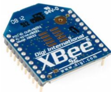
Figura 3-15: Radio transmisor y receptor con ADC 10 Bits Digitales I/O 2.4GHz Alcance (50 metros)
