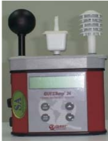
Fig. 11. Monitor de estrés térmico. Fuente: Creada para la presente obra.
