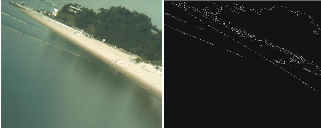
**Figura 7.** Imagen tomada de La Magdalena (izquierda) y los respectivos bordes hallados con el método de *Canny* (derecha).
