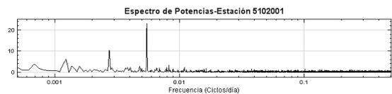
**Figura 12.-** Espectro de potencias (Fourier), estación 5102001, Cuenca del río Patía
