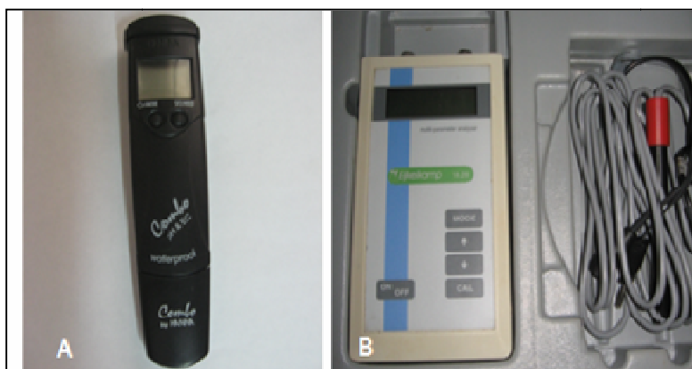
Imagen 4: Equipo portátil de análisis físico-químico de aguas: A. Multiparámetro marca HANNA, modelo HI 9819. B. Multiparámetro marca EIJKELKAMP, modelo 1828.
