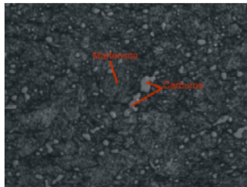
Figura 4-4: Micrografía de Acero AISI M2 2000X.
