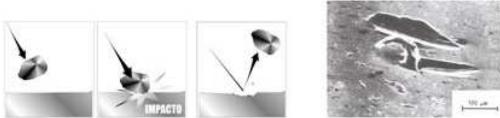
Figura 2-16: Desgaste por Erosión [91].
