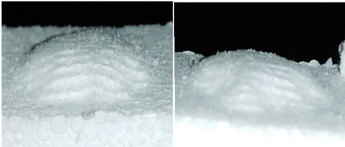
Figura 4-11.: Mecanizado de superficie libre sin cambio de orientación de la herramienta
