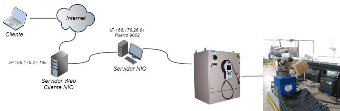
Figura 3-2.: Esquema de comunicación inicial del sistema
