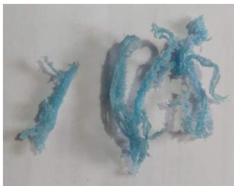
Figura 4-7.: Viruta obtenida en el proceso de mecanizado de pieza plástica
