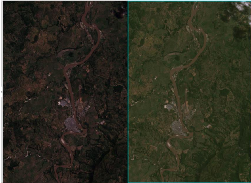
Figura 4-8 Comparación de imagen original (izquierda) vs imagen corregida (derecha) radiométricamente Fuente: Propia
