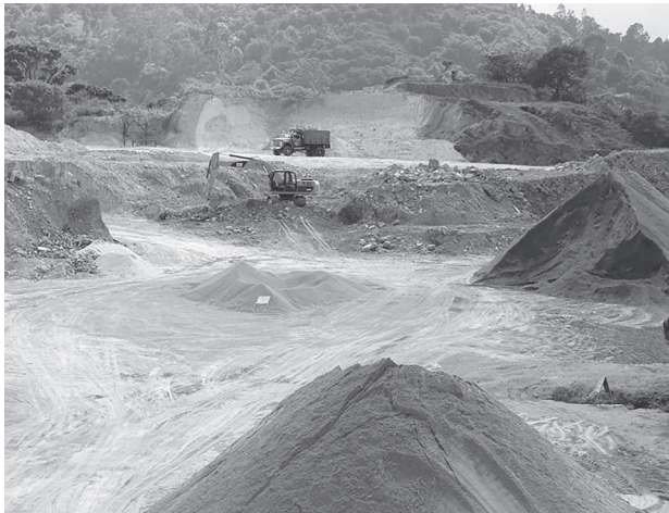
Fotografías 55 y 56. Almacenamiento de agregados reciclados; prefabricados en concreto con agregados reciclados. Indural S.A. (Fuente: Bedoya, C.; 2012)
