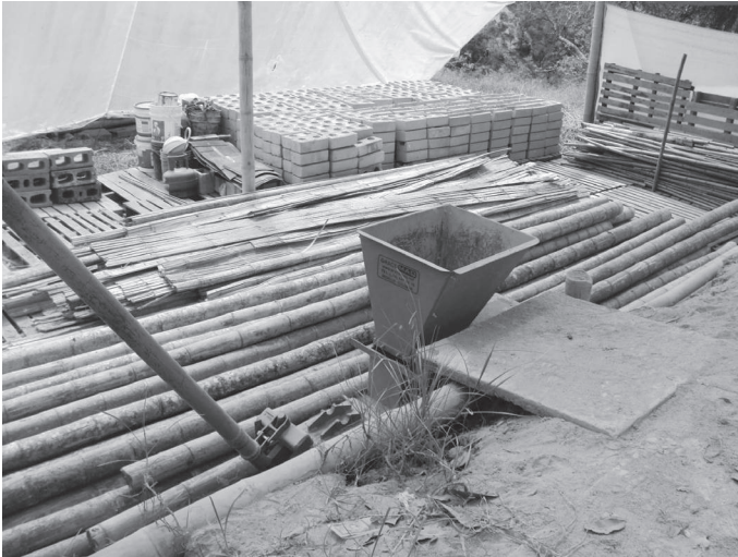
Fotografía 21. Detalle de la tolva de alimentación para la Cinva-Ram. (Fuente: Bedoya, C. 2014).
