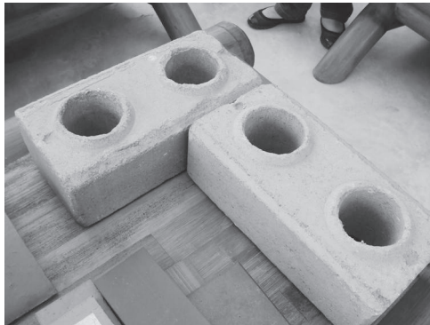
Fotografía 22. Bloques de suelo cemento aligerados (Fuente: Bedoya, C. 2014).
