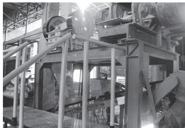
Las fotografías 57, 58, 59 y 60 muestran la tipología de RCD empleados, el transporte al CIMEX y la planta de trituración, en este caso el equipo de trituración primaria de mandíbulas o quijadas. (Fuente: Bedoya, C.; 2012).
