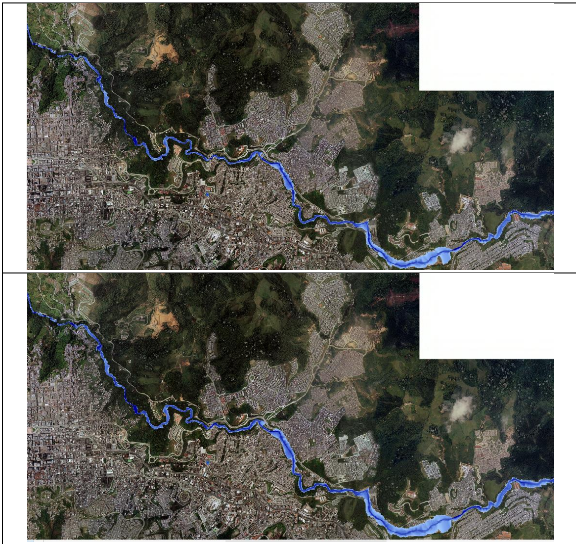
Figura 9. Mancha de inundación de la Q. Olivares–Minitas, para un Tr: 25 y 100 años
