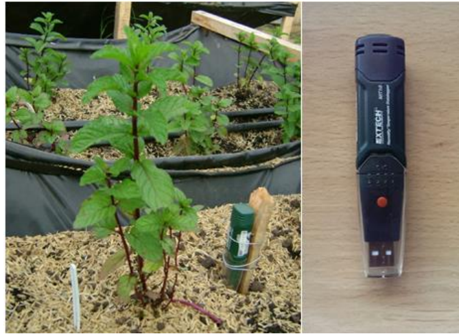
Ilustración 2-9: Dataloggers Extech instruments® ubicado a la altura de la planta. (Fuente: Propia.)
