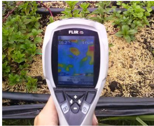
Ilustración 2-7: Cámara termográfica Flir Systems® Modelo A40M. (Fuente: Propia.)
