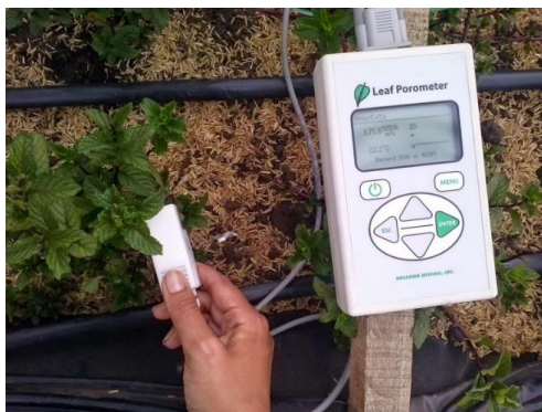
Ilustración 2-5: Porómetro de hoja para muestras de conductancia estomática en Hierbabuena Decagon Devices® (Fuente: Propia)
