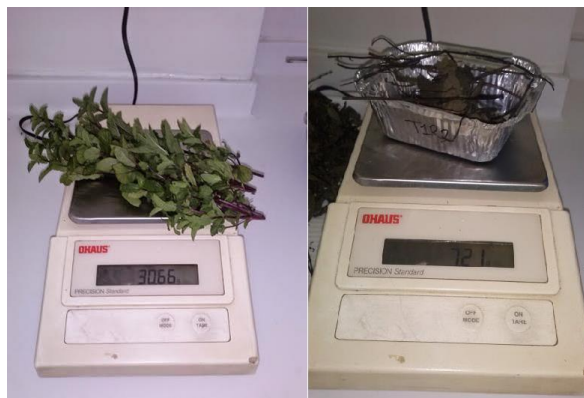
Ilustración 2-12: Lectura de la masa fresca (Izq.) y la masa seca (Der.). (Fuente: Propia.)
