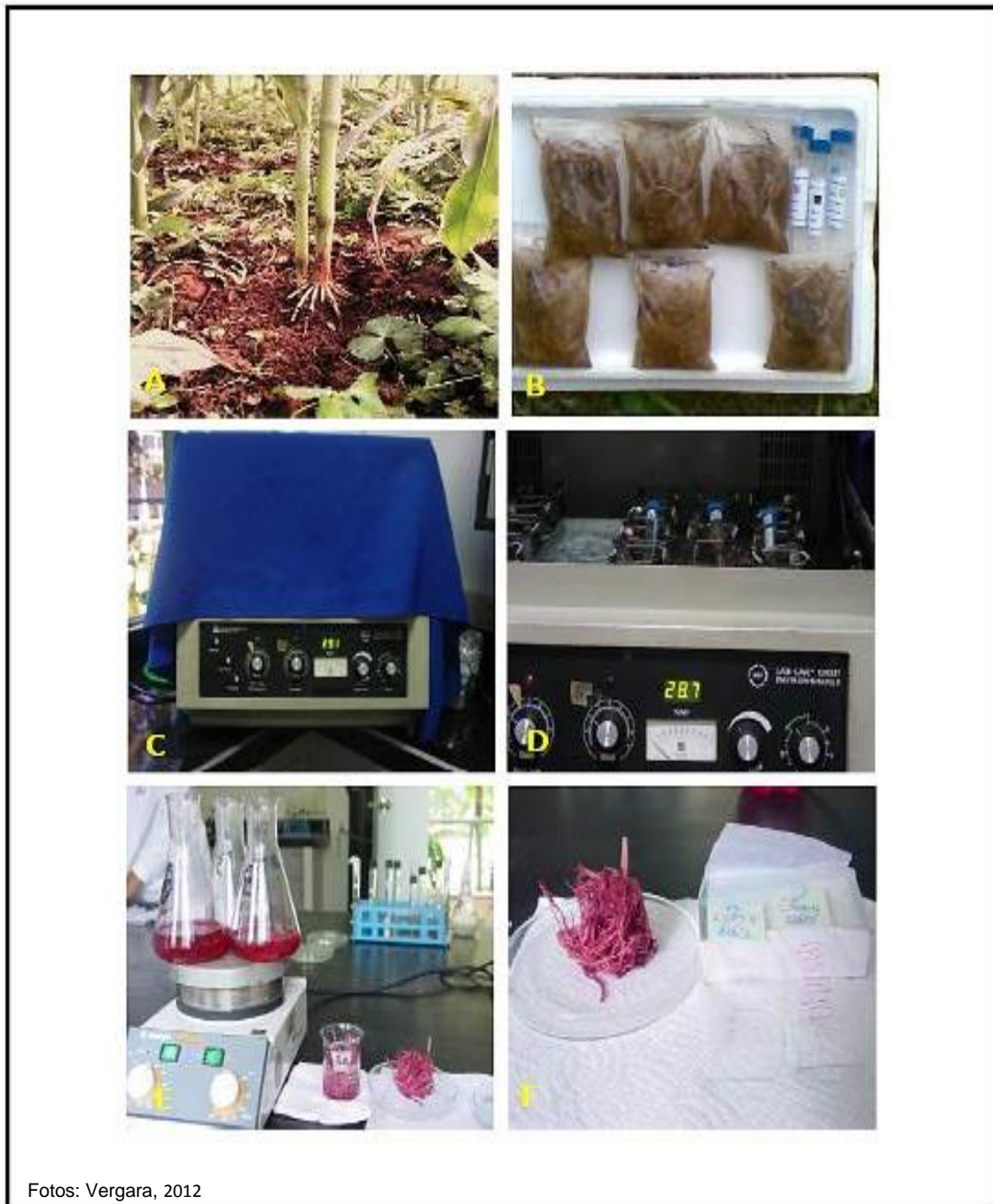
Figura 12. Algunas etapas de la técnica de tinción de MV con fucsina ácida: (A, B) recolección de raíces; (C, D) incubación de raíces en oscuridad; (E, F) tinción de raíces y montaje de placas.
