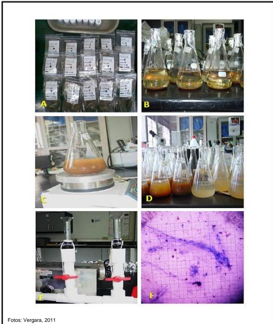
Figura 13. Pasos para la técnica de tinción de ME: (A) preparación de suelo; (B, C, D) dispersión del suelo para extraer ME; (E) tinción y filtración al vacío de micelio; (F) Filtro millipore de 1.2 micras con micelio teñido previo a la observación con objetivo 20x.
