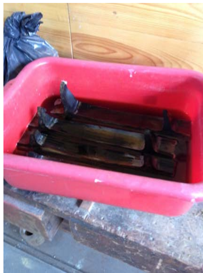
Figura 26: Cepillado manual de las muestras.
