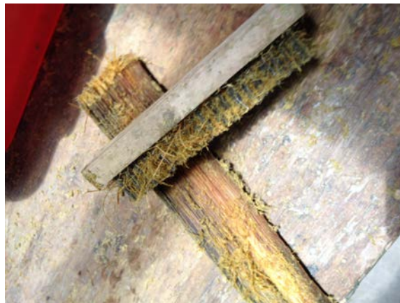
Figura 26: Cepillado manual de las muestras.
