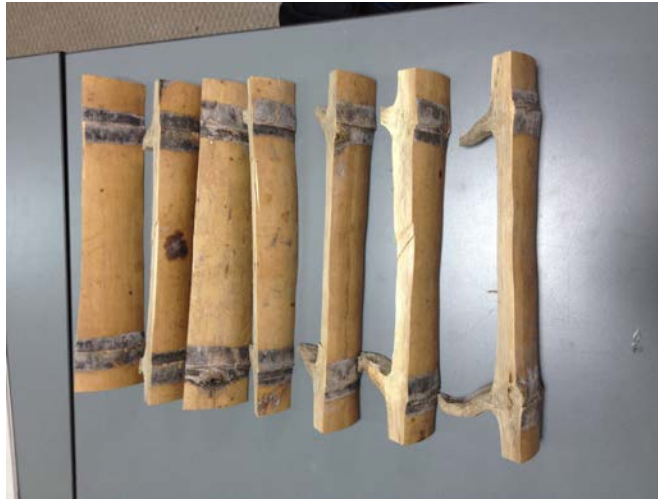
Figura 24: Guadua de desecho implementada para obtener la fibra bajo prueba
