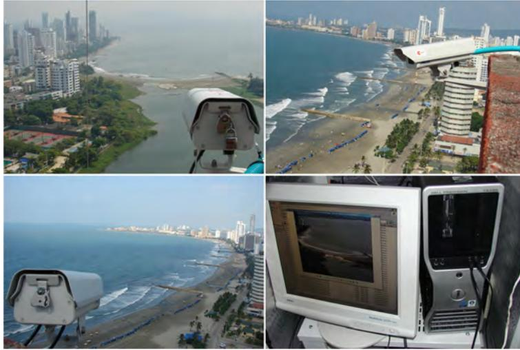
Figura 2-1: Cámaras (Dentro de sus carcazas protectoras) usadas en la estación de captura HORUS en Cartagena y PC de control.
