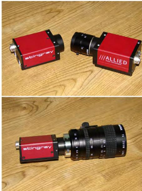
Figura 2-2: Cámaras STINGRAY y MARLIN, usadas en las estaciones de captura HORUS.
