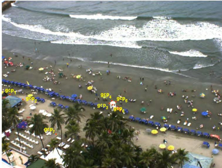
Figura 5-14: Foto de 1024 x 768 píxeles, correspondiente a la cámara 1 de la estación HORUS Cartagena y los puntos de control usados para calibrarla.
