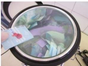
Ilustración 15 Recipiente de almacenamiento Nitrógeno líquido. Pasantía UNAL- UB 2013 FEH-U
