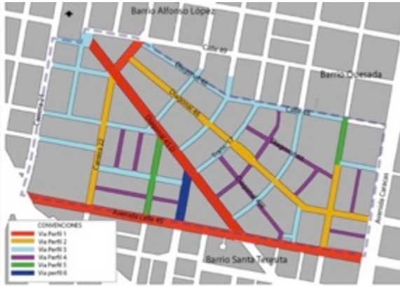
Ilustración 342. Estructura vial del barrio Palermo según perfiles
