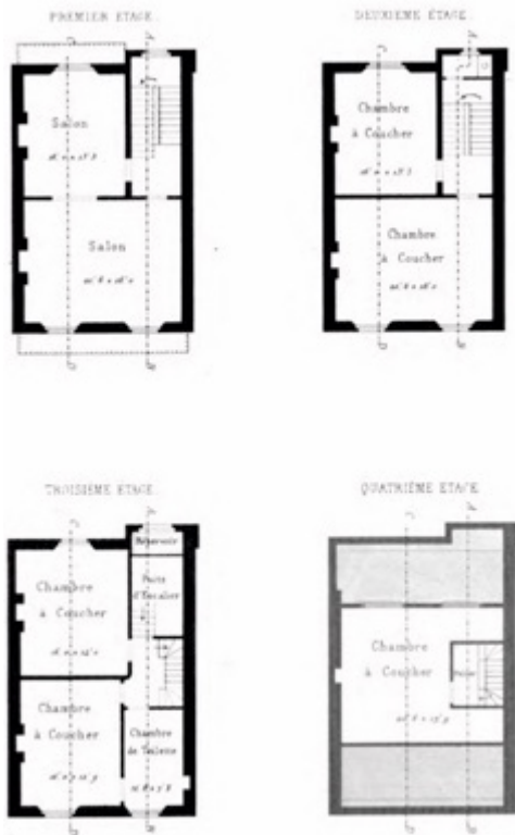
Ilustración 243. La típica casa londinense consistente en seis niveles. Alzados y plantas de una casa de tercera clase. Lowndes Street. (OLSEN, 1986) Tomado de: Revue generale de l'architecture (1855) Pág. 20 - 21
