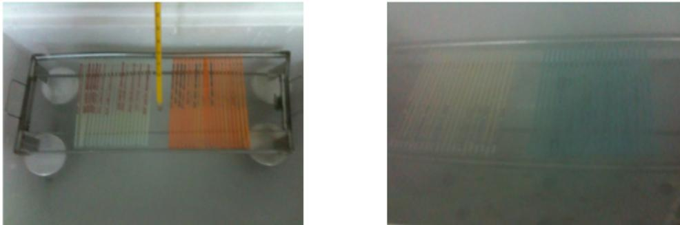
Figura 2.2.2.1. Descenso de temperatura en vapores de nitrógeno antes de ser sumergidos en el nitrógeno líquido.
