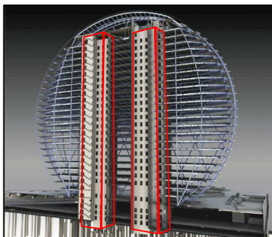
Ilustración 6. Esquema de la ubicación de los elementos del edificio Aldar HQ
