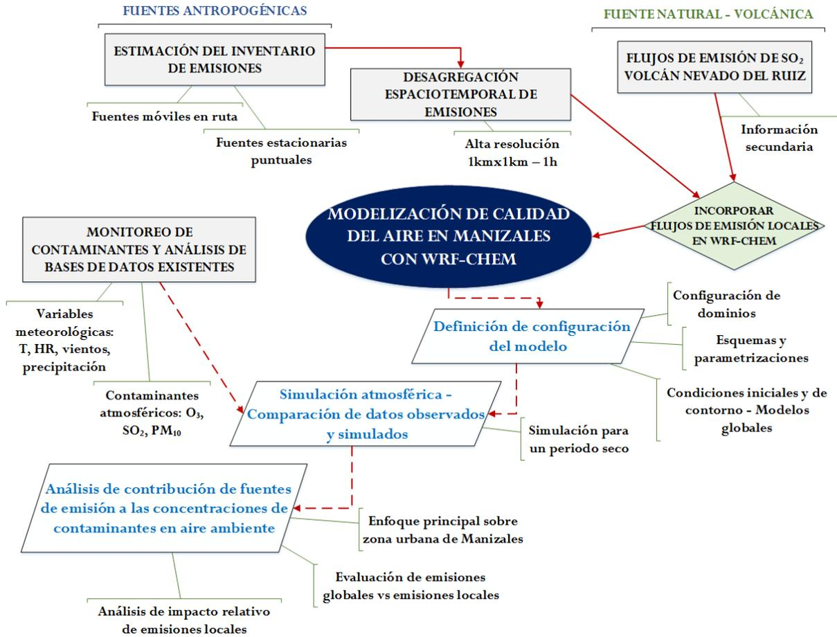
**Figura 1.4. Componentes y objetivos específicos necesarios para llevar a cabo la simulación de calidad del aire en Manizales utilizando el modelo euleriano de transporte químico WRF-Chem.**
